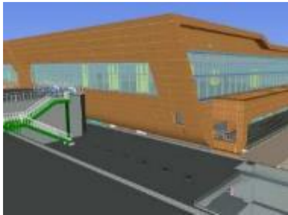
工序規劃方案2： 先搭設帷幕牆施工架，再安裝冷卻水塔。 結果：施工架占用冷卻水塔安裝空間。✗不可行
