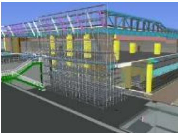
工序規劃方案2： 先搭設帷幕牆施工架，再安裝冷卻水塔。 結果：施工架占用冷卻水塔安裝空間。✗不可行
